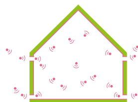
Maisons non isolées (autrefois): avec enveloppe du bâtiment perméable à l'air*
